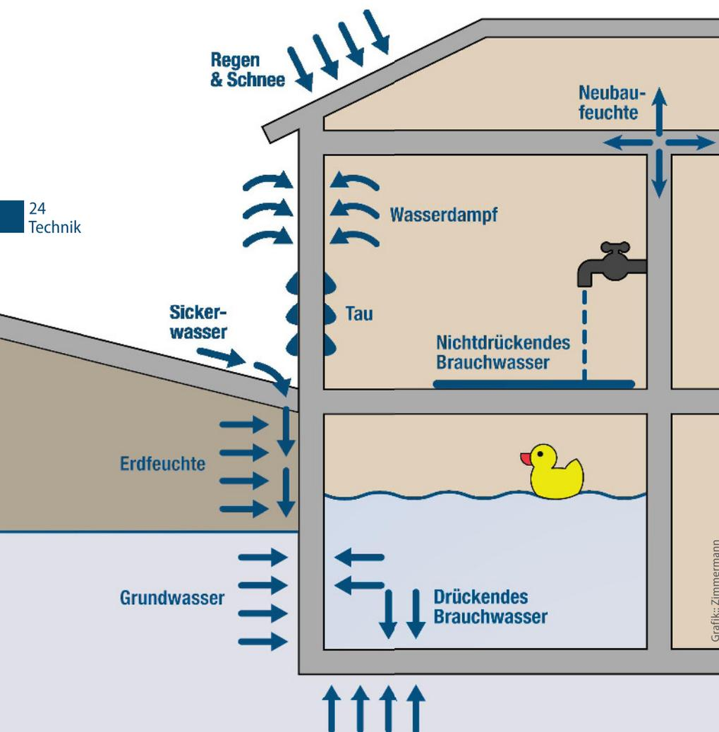
Feuchtigkeit kann auf verschiedenen Wegen an und in Gebäude oder Bauteile gelangen. Neben Undichtigkeiten kommt es häufig durch Neubaufeuchte oder Materialfeuchte zu Schäden. Ein gutes „Feuchtemanagement“ ist hier wichtig.
