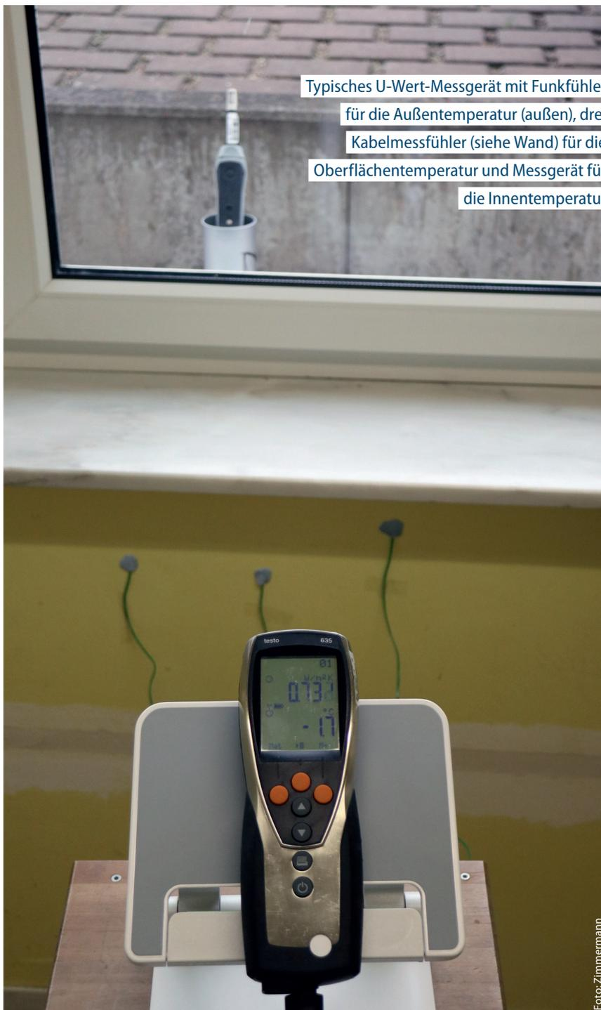
Typisches U-Wert-Messgerät mit Funkfühler für die Außentemperatur (außen), drei Kabelmessfühler (siehe Wand) für die Oberflächentemperatur und Messgerät für die Innentemperatur
